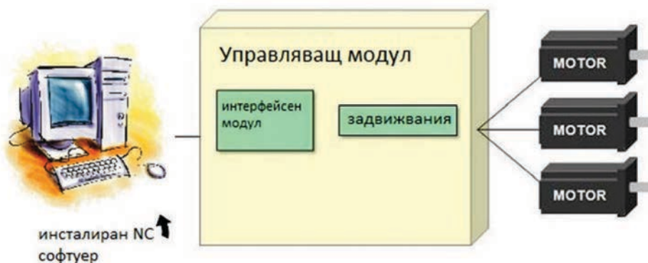
Фигура 1. Принципна схема на управление, базирано на персонален компютър
