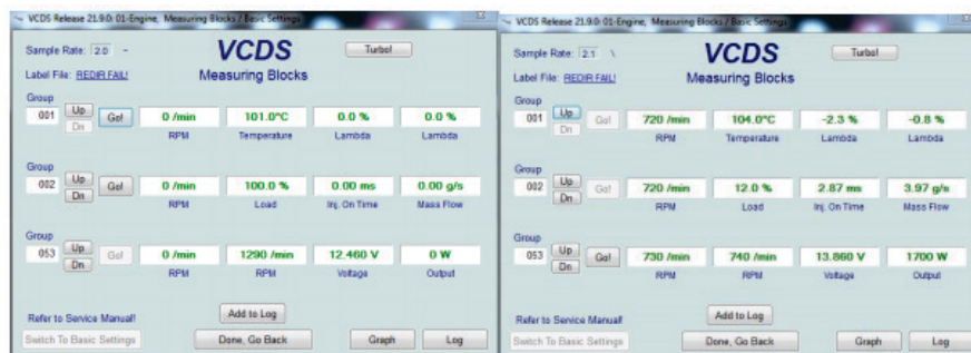
Фигура 6. Данни от работа в реално време на блока за управление на мотора
