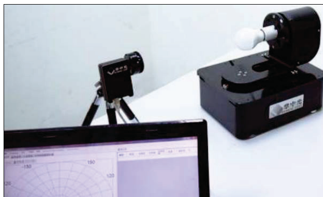
Фигура 1. Гониофотометър с прикрепен спектрофотометър
