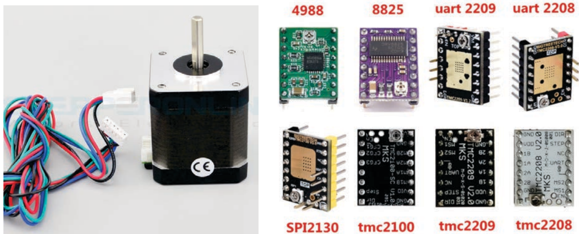
Фигура 4. Външен вид на избрания стъпков двигател (а) и маломощни стъпкови драйвери (б)
